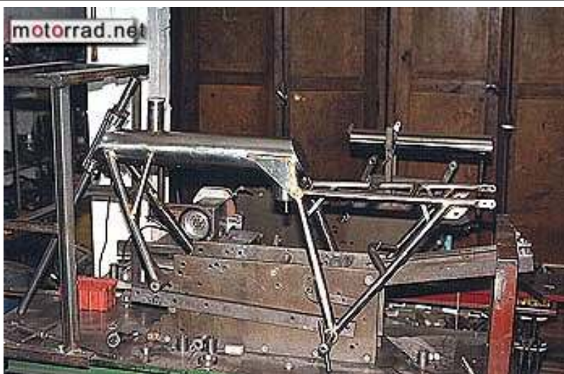
An actual Egli frame on a frame jig.
